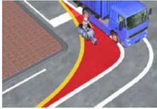
機車應與大型車保持安全間距以免因內輪差而被輾入輪下
